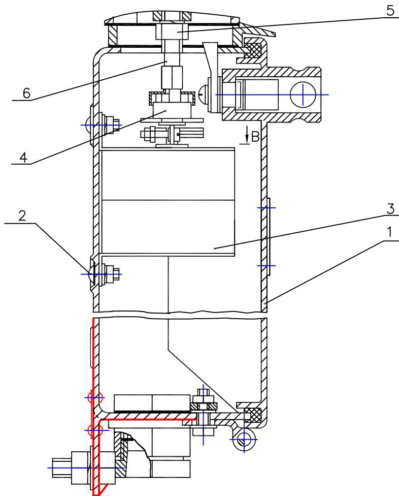
1 - крышка; 2 - винт; 3 - переключающее устройство; 4 - муфта; 5 - гайка; 6 - ось
