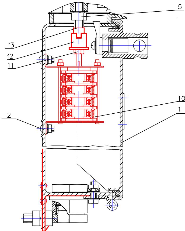
1 - крышка; 2 - винт; 5 - гайка; 10 - коммутирующее устройство; 11 - гайка; 12 - втулка; 13 - ось
